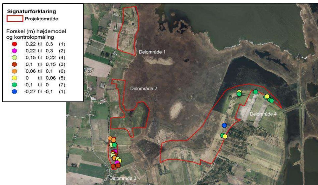
Figur 5: Kontrol af den digitale højdemodel i forhold til indmålte terrænkoter i felten.
